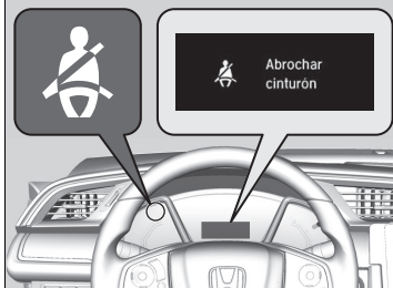
Modelos con interfaz de información del conductor
