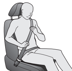
Ajuste el cinturón de seguridad de dos puntos lo más bajo posible.
